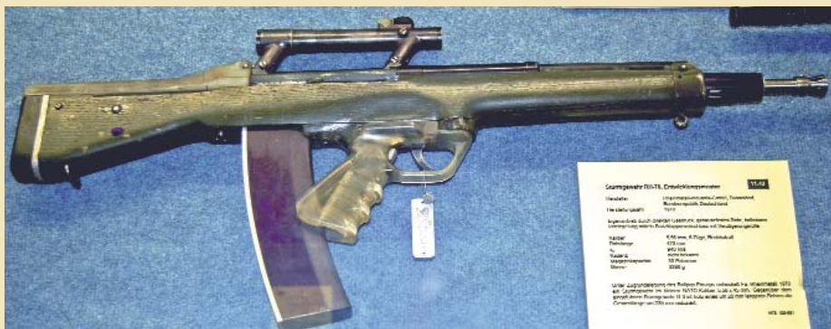
RH-70 - Опытная винтовка RH-70 фирмы Rheinmetall под патрон 5,56 x 45 мм. Разработана в 1970 г. для замены винтовки G3, также имела роликовый полусвободный затвор. За счет компоновки «буллпап» длина оружия сократилась на 235 мм
