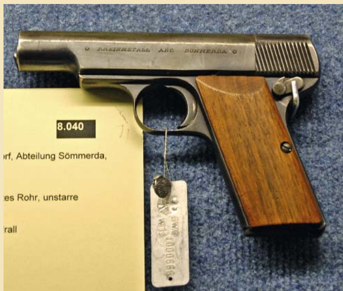
Rheinmetall-Pistol - 7,65-мм карманный пистолет со свободным затвором, выпускавшийся фирмой Rheinmetall в 20-е годы.
