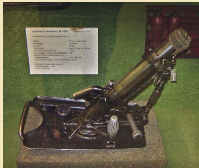
Mortar M1936 50 mm - Легкий миномет калибра 50 мм образца 1936 года фирмы Rheinmetall-Borsig AG
